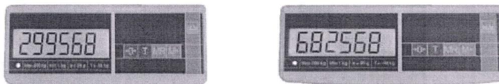
Рисунок 2 – Примеры индикация кода юстировки
